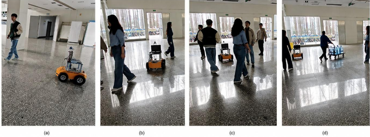
图 21 无人车实际运动过程：(a) 启动；(b) 动态障碍物阻挡后倒车重规划；(c) 穿越多行人区域；(d) 到达终点 Fig. 21 UGV motion sequence: (a) startup; (b) reversing replanning under a dynamic obstacle; (c) traversing a multi-pedestrian area; (d) reaching the destination
